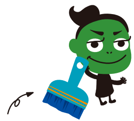
糊刷毛(のりはけ) 広い面積に糊をつけるときに使う道具
